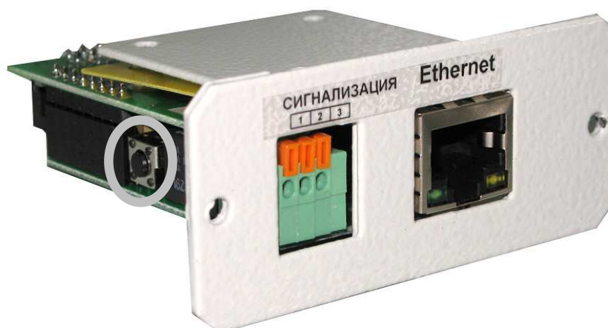
Рисунок 2.1 – Кнопка перезагрузки изделия и возвращения стандартных настроек
